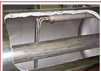
**Рис. 1.** Криогенный бак для СПГ с экранно-вакуумной теплоизоляцией
