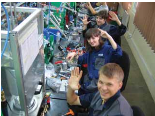
Рис. 1. Работа студентов на конвейере по сборке газовых редукторов
