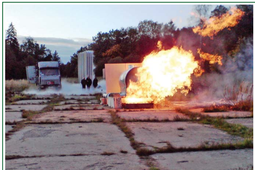
Рис. 2. Огневое испытание заполненной сжиженным природным газом цистерны с конструктивной огнезащитой
