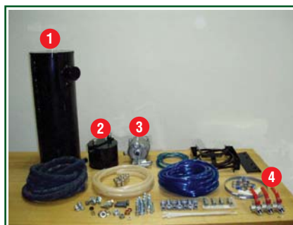
Рис. 4. Комплект дополнительного оборудования по адаптации топливной системы тракторов для работы на рапсовом масле: 1 – дополнительный бак; 2 – теплообменник; 3 – фильтр тонкой очистки; 4 – трехходовой кран
