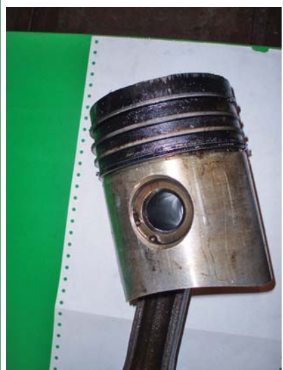
Рис. 9. Поршни двигателя Д-441 после 100 ч работы на чистом рапсовом масле
