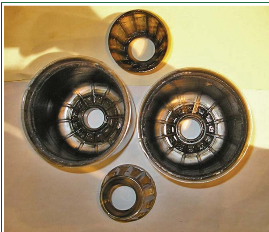
Рис. 10. Отложения в центрифуге двигателя Д-440 после 100 ч работы на чистом рапсовом масле
