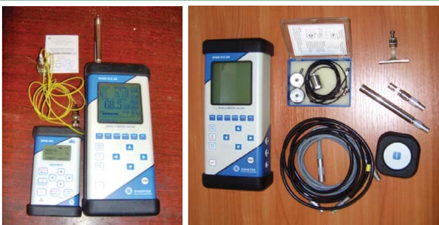
Рис. 5. Оборудование для снятия виброакустических параметров во время движения автомобиля
