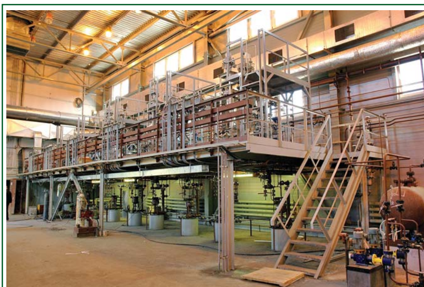
Рис. 3. Стендовые установки для отработки технологий производства синтетических жидких топлив
