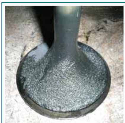
Рис. 6. Клапан цилиндровой крышки тепловоза ЧМЭЗ с 10%-ной концентрацией биотоплива через два месяца после начала испытаний
