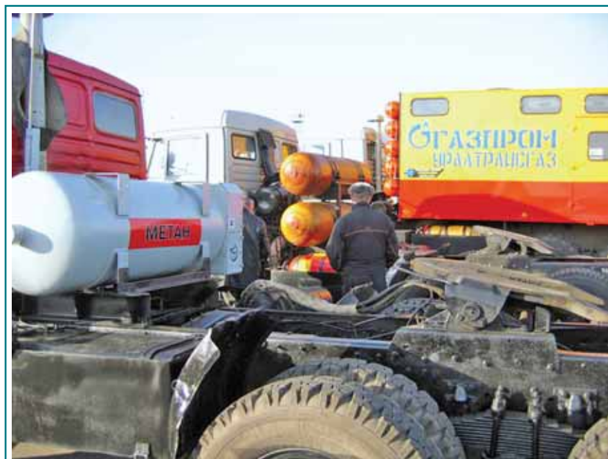
«КАМАЗ-5410» с криогенным баком БКТ-300
