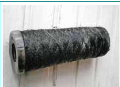
Рис. 4. Элемент топливного фильтра чистой очистки тепловоза ЧМЭЗ с 20%-ной концентрацией биотоплива через два месяца после начала испытаний
