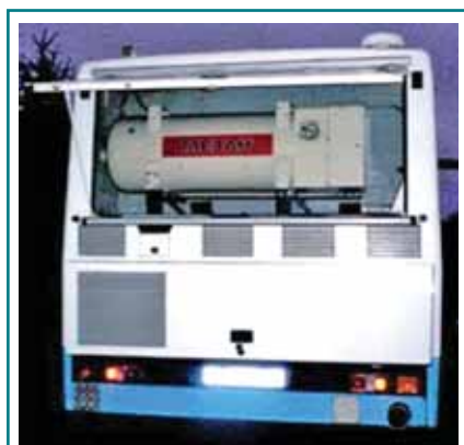
Автобус «НЕФАЗ-5299» с криогенным баком БКТ-300/1,0
