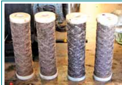
Рис. 7. Элементы фильтров тонкой очистки тепловоза ЧМЭЗ с 20%-ной концентрацией биотоплива в конце испытаний
