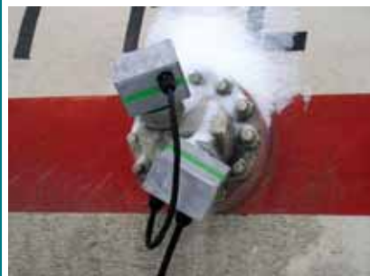
Рис. 5. Боковая установка датчиков ДЖС-7
