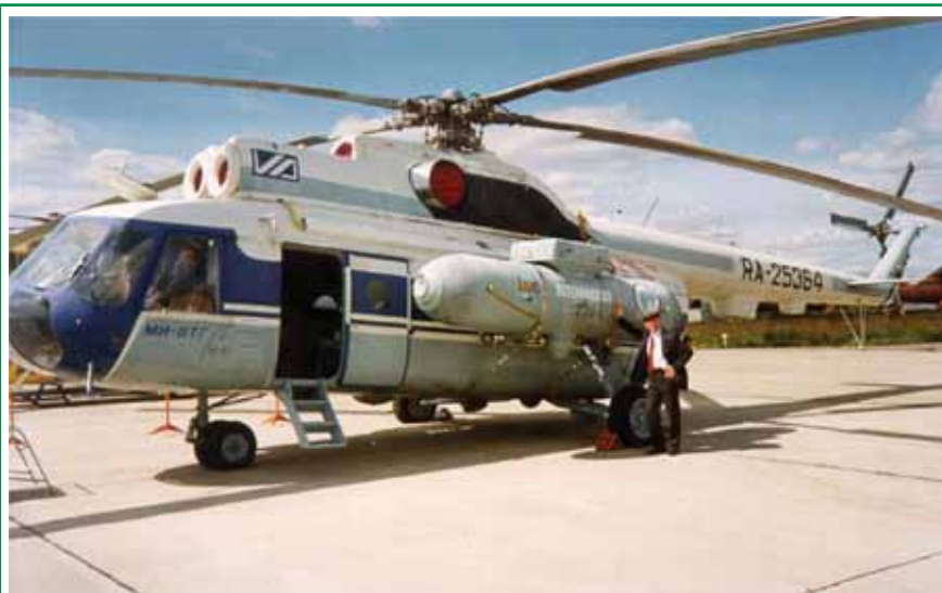
Рис. 3. Газолет – вертолет Ми-8ТГ на газовом топливе в серийном исполнении, рассчитанный на эксплуатацию на АСКТ и авиакеросине
