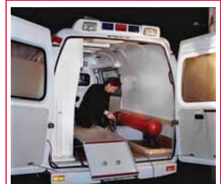
Установка газового оборудования на «Скорую помощь» («Газель»)
