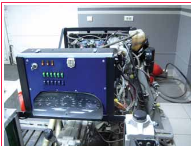
Рис 1. Стендовое испытание двигателя ЗМЗ–4062.10 с ЭСУД Bosch M1.5.4 и Микас 5.4
