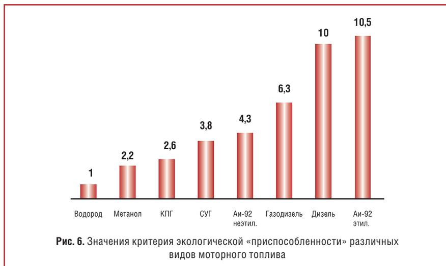
Рис. 6. Значения критерия экологической «приспособленности» различных видов моторного топлива
