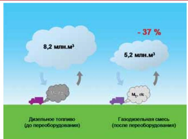
**Рис. 2.** Количество воздуха, требуемого для рассеивания вредных веществ в отработавших газах 58 дизельных автомобилей, переоборудованных для работы по газодизельному циклу в ООО «Оренбурггазпром»
