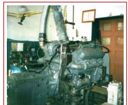
**Рис. 5.** Газодизельный двигатель ЯМЗ-236HE
