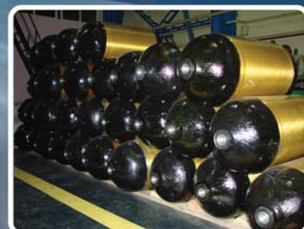
Баллоны систем пожаротушения На рабочее давление 4 МПа
