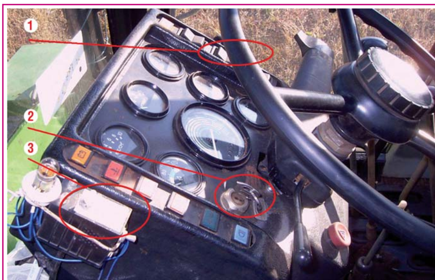
Рис. 5. Панель кабины водителя трактора РТМ-160 с прибором управления режимами работы трактора: 1 – тумблер включения питания; 2 – ключ зажигания; 3 – панель управления режимами работы двигателя
