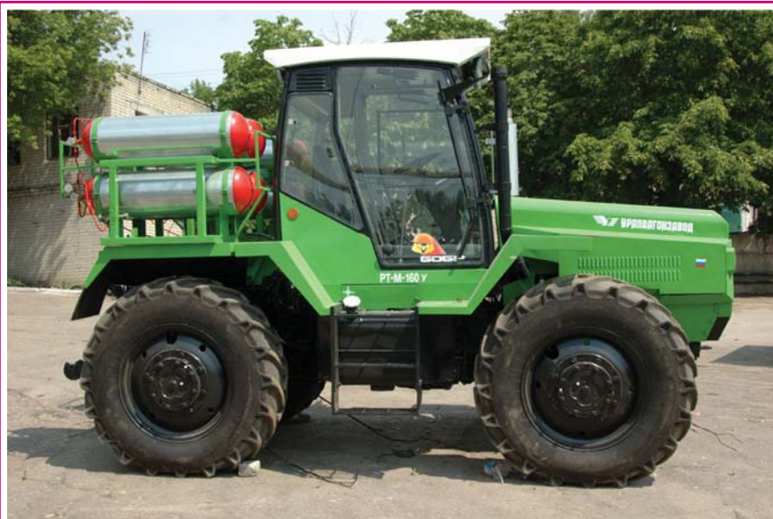
Рис. 1. Общий вид трактора РТМ-160 с установленным на нем газобаллонным оборудованием
