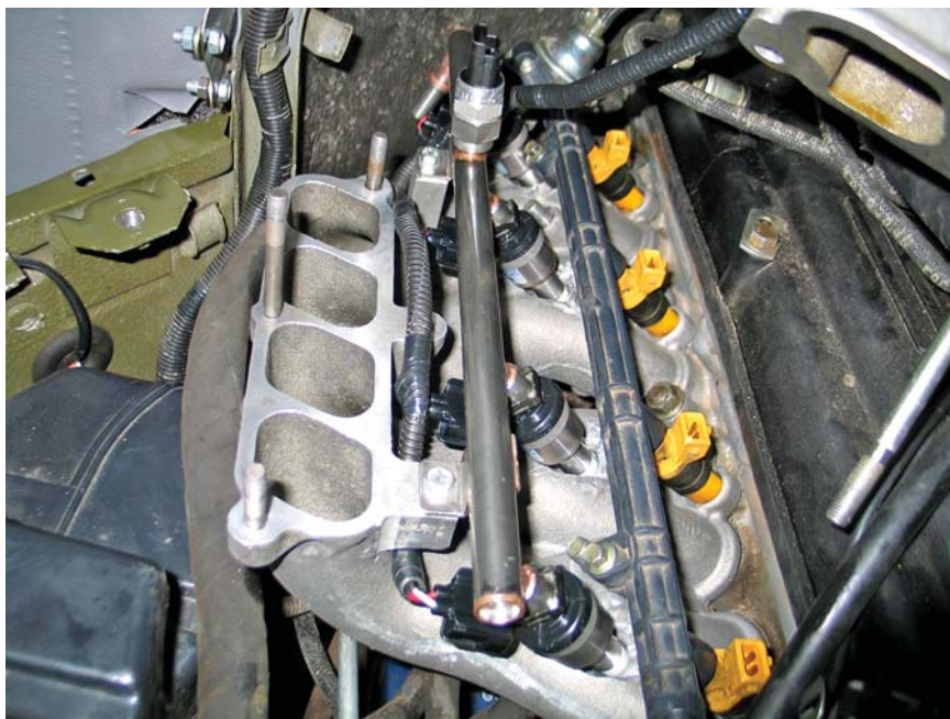
Рис. 4. Расположение топливных рамп двигателя 3МЗ-4091
