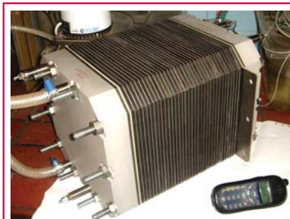
Рис. 2. Топливный элемент на основе твердого полимерного электролита мощностью 5 кВт, разработанный в РНЦ «Курчатовский институт»
