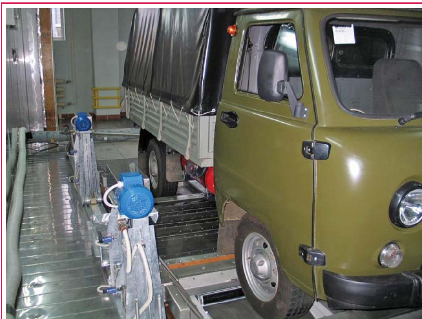
Рис. 2. Битопливный автомобиль «УАЗ» с двигателем ЗМЗ-4091 и системой Микас 12М на испытательном стенде с беговыми барабанами в холодильной камере
