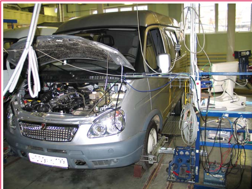
Рис. 3. Битопливный автомобиль «Соболь» с двигателем ЗМЗ-40524 и системой Микас 12М на испытательном стенде с беговыми барабанами
