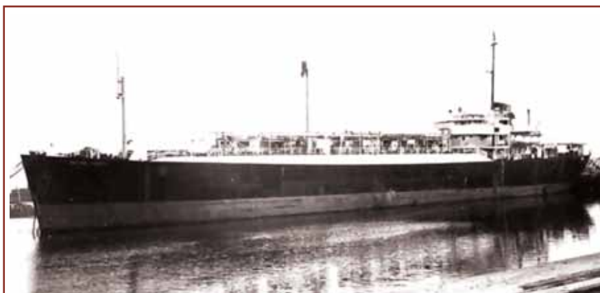
Рис. 1. Сухогруз Methane Pioneer, перестроенный в танкер для перевозки СПГ [7]
