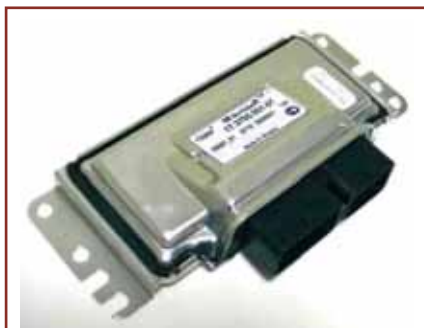
Рис. 2. Контроллер Микрайдер подчиненной системы управления двигателем с искровым зажиганием
