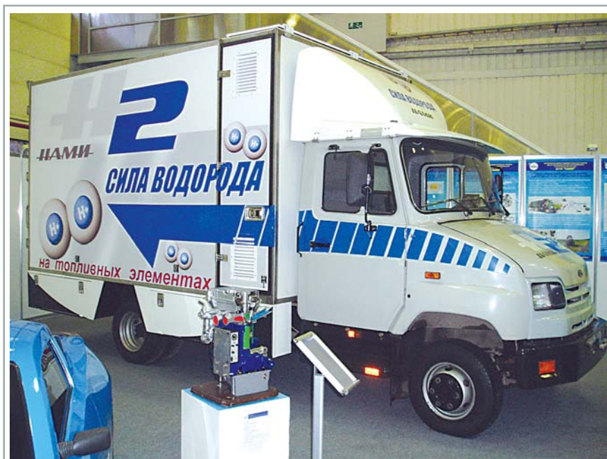
Рис. 2. Автомобиль «Бычок» с энергетической установкой на основе ЭХГ
