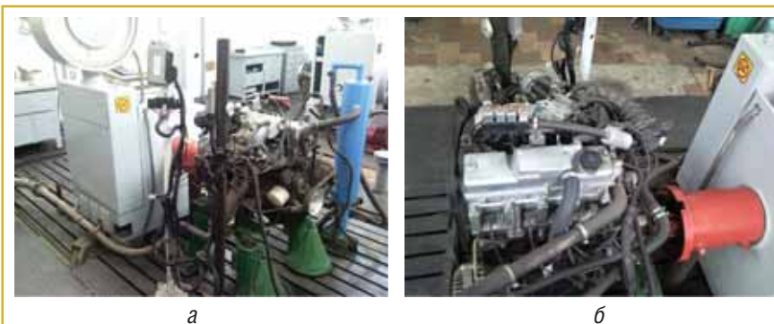
Рис. 3. Моторный стенд (а) для контрольно-регулирующих работ на ГБА и схема (б) размещения газовой аппаратуры на стенде
