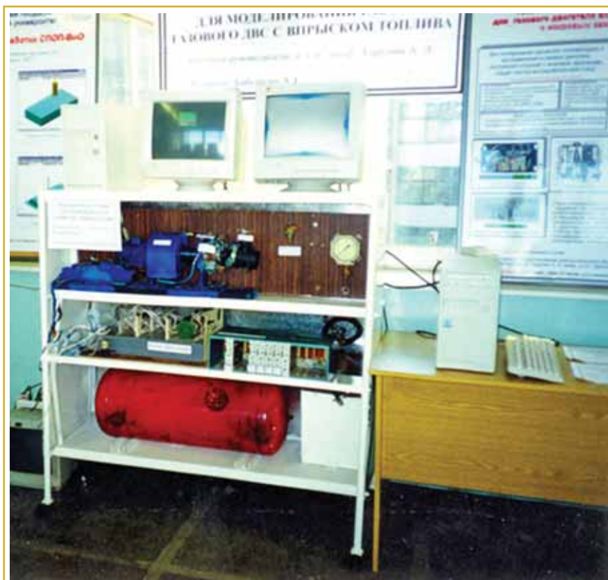
Рис. 2. Общий стенд для контроля, регулировки и диагностики элементов систем топливоподачи и воспламенения газового ДВС с искровым зажиганием
