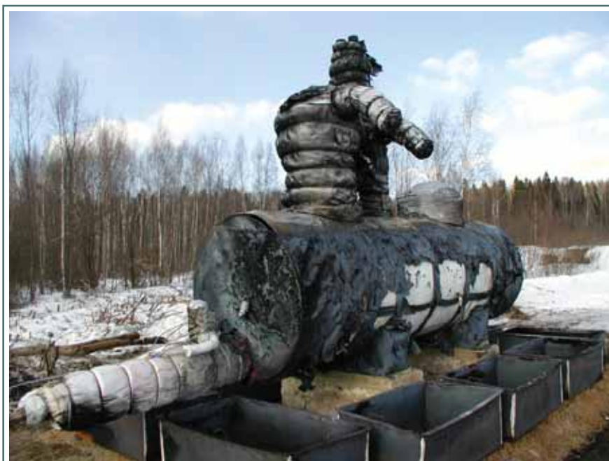
Рис. 3. Состояние объекта испытаний после огневого воздействия в течение 80 мин
