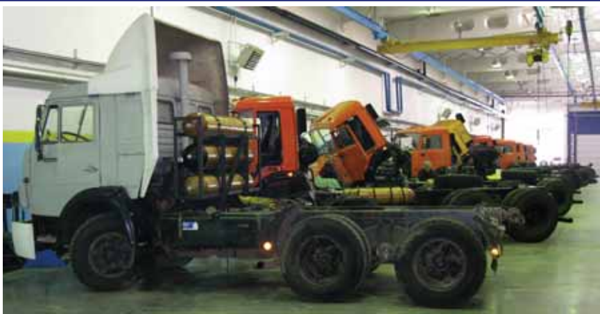
Рис. 3. Участок установки ГБО «РАРИТЭК-1-КАМАЗ» на автомобиль с дизельным двигателем
