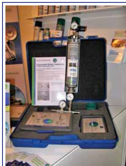
Рис. 4. Комплект оборудования фирмы «TUNAP» для промывки газовых форсунок на автомобиле
