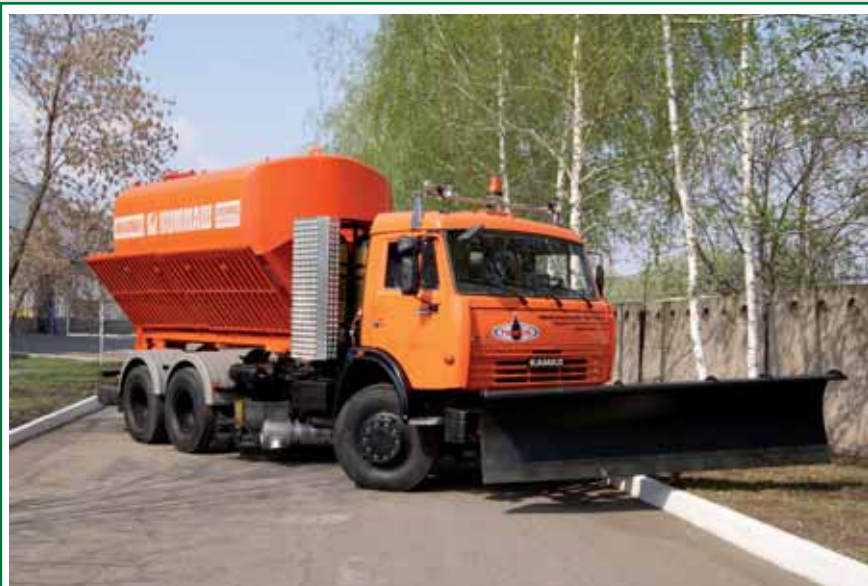
Рис. 1. Комбинированная дорожная машина К0-829Б1 с газовым двигателем
