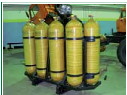
Рис. 3. Кассета металлокомпозитных баллонов, расположенных за кабиной
