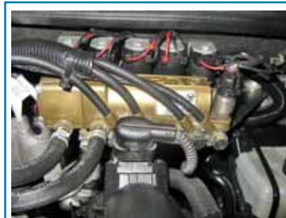
Автомобиль Škoda Octavia с системой подачи газа непосредственно в цилиндр
