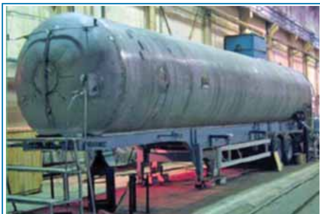
Рис. 5. Автомобильная цистерна ОАО «Криогенмаш» ЦТВ-45/1,0 на вакуумных испытаниях [27]
