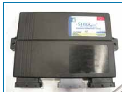
Блок управления газовой системой питания с функцией взаимодействия с EOBD
