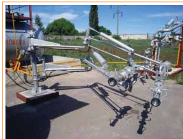
Рис. 3. Устройство для налива автоцистерн с быстроразъемными механизмами
