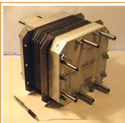
Рис. 3. Бифункциональный электрохимический модуль, разработанный НИЦ «Курчатовский институт»
