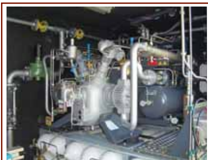
Рис. 3. Компрессор СВК 24.11-68 с прямым приводом
