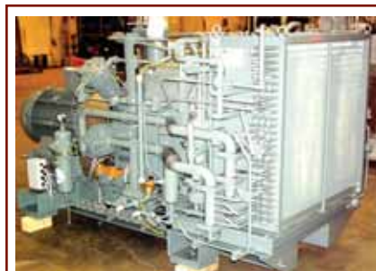
Рис. 2. Компрессор ЛМФ V17GN-5518 L25/35 для АГНКС
