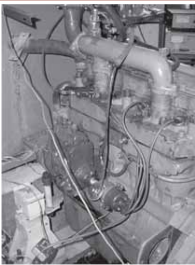
Рис. 1. Газовый двигатель, переоборудованный из дизеля Д-240
