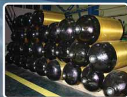
Баллоны систем пожаротушения На рабочее давление 4 МПа
