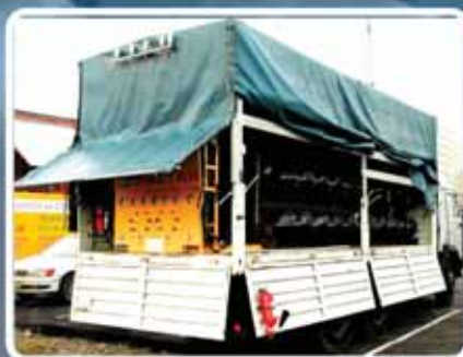
Баллоны для сжатого природного газа На рабочее давление 20 МПа
