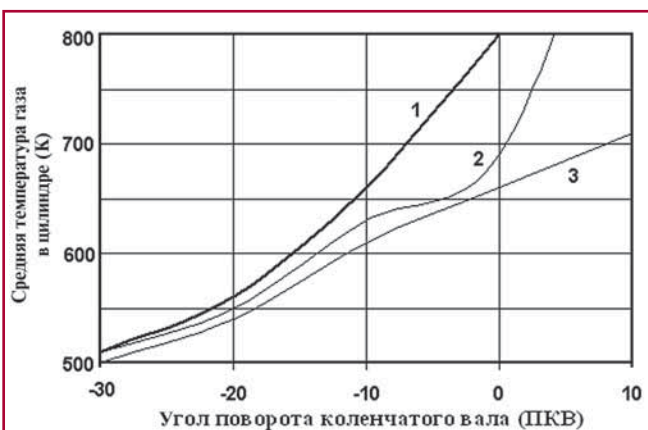
Рис. 4. Средняя температура газа в цилиндре на момент начала воспламенения в зависимости от пропорции СПГ и ДМЭ в смеси: 1 – \alpha_{\text{СПГ}} = 6,6 ; \alpha_{\text{ДМЭ}} = 10,3 ; 2 – \alpha_{\text{СПГ}} = 4,4 ; \alpha_{\text{ДМЭ}} = 11,7 ; 3 – \alpha_{\text{СПГ}} = 2,9 , \alpha_{\text{ДМЭ}} = 11,5
