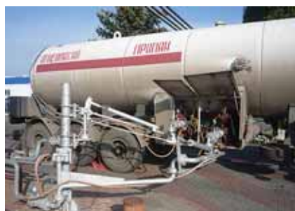
Рис. 6. Операции наполнения газовоза СУГ с помощью шарнирных трубопроводов
