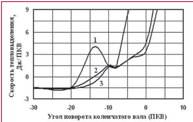
Рис. 3. Скорость тепловыделения в зависимости от пропорции СПГ и ДМЭ в смеси: 1 – \alpha_{\text{СПГ}} = 6,6 ; \alpha_{\text{ДМЭ}} = 10,3 ; 2 – \alpha_{\text{СПГ}} = 4,4 ; \alpha_{\text{ДМЭ}} = 11,7 ; 3 – \alpha_{\text{СПГ}} = 2,9 , \alpha_{\text{ДМЭ}} = 11,5
