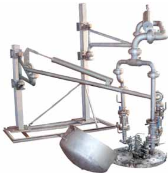
Рис. 5. Конструкция стального шарнирного трубопровода в рабочем состоянии
