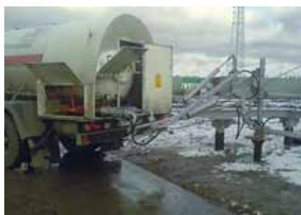
Рис. 6. Операции наполнения газовоза СУГ с помощью шарнирных трубопроводов
