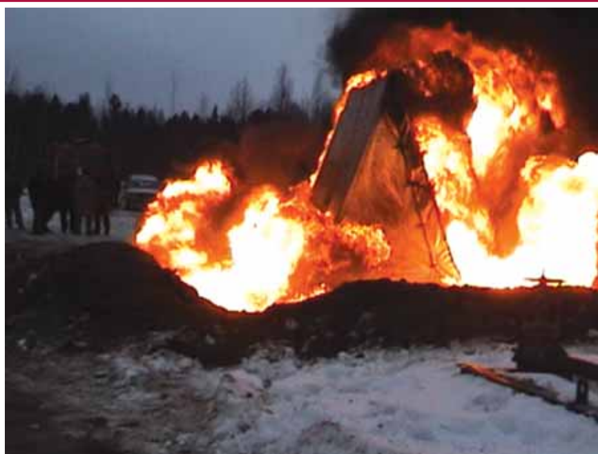
Рис. 4. Характерный момент огневых испытаний огнезащитного укрытия
