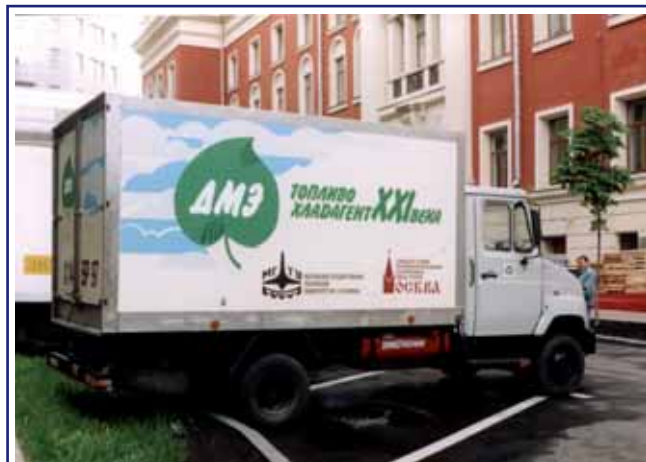
Рис. 9. Опытный автомобиль МГТУ им. Н.Э.Баумана с моторной и холодильной установками, работающими с ДМЭ (эксплуатируется с 2002 г.)
