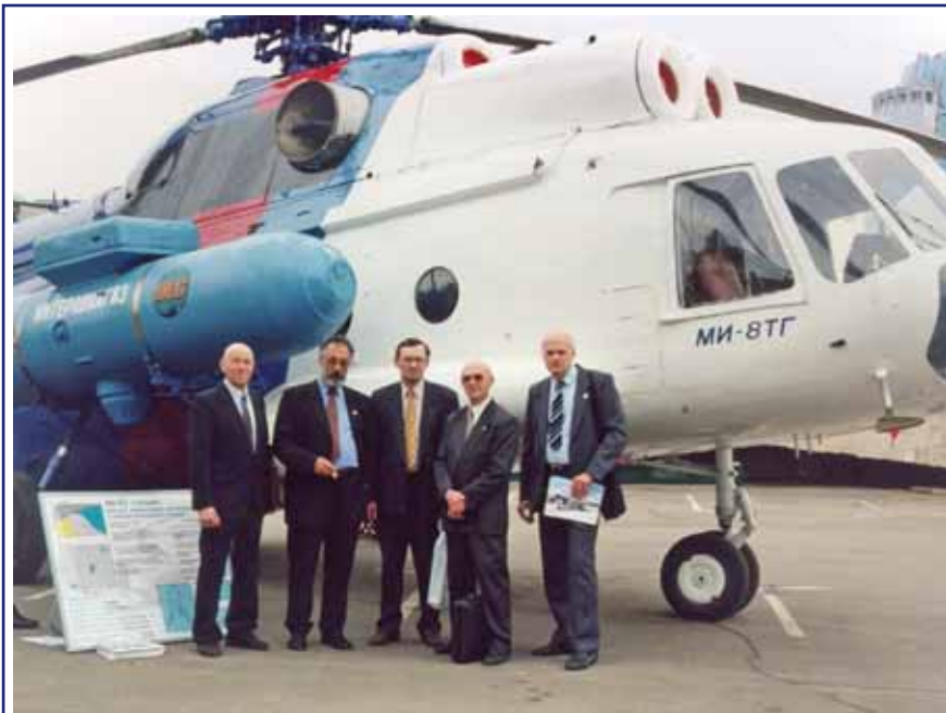
Опытно-промышленный двухтопливный вертолет-газолет Ми-8ТГ в серийном исполнении
