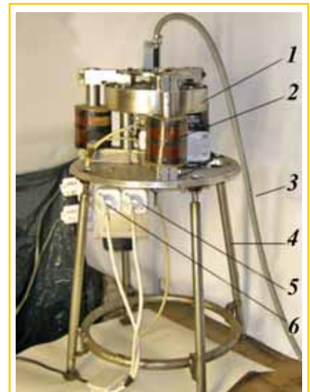
Рис. 2. Электроводородный генератор с магнитом ЭВГМ: 1 – ротор; 2 – соленоид; 3 – шланг для отвода газа; 4 – рама; 5 – питание электродвигателя; 6 – питание электромагнита
