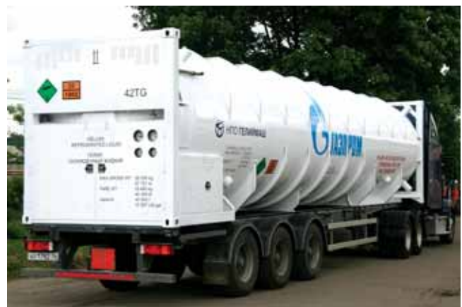
Цистерна ЦТГ-40/0,45 перед транспортными испытаниями
