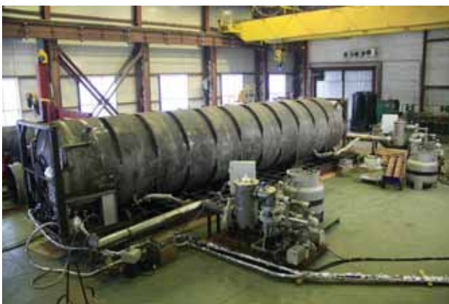
Вакуумирование изоляционной полости ЦТГ
