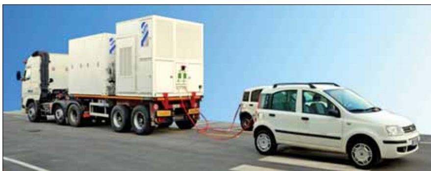
Заправка автомобиля метаном, которую осуществляет ПАГЗ с полимерно-композитными баллонами и мобильным компрессорным блоком
