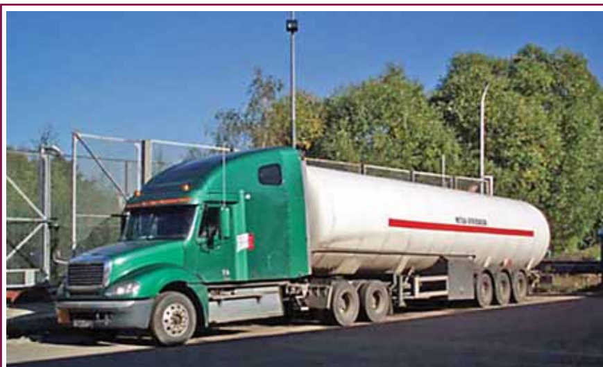
Рис. 5. Газовоз СПГ объемом 56 м 3
