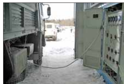
Выпуск газа из пришедшего на ремонт автомобиля (г. Красноуральск)
