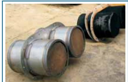
Сравнение автомобильных барабанных фильтров после работы на ВТЭ (на переднем плане) и на 100%-ном дизельном топливе (на заднем плане).
