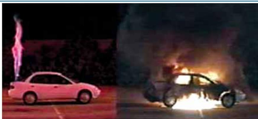
Рис. 4. Внешний вид горящих водородного (слева) и бензинового автомобилей через 1 мин после поджига [8]
