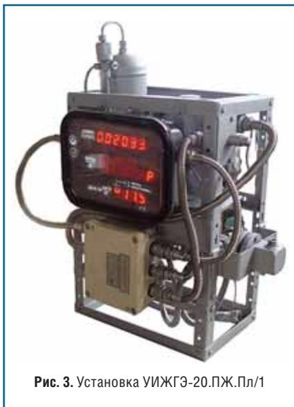
**Рис. 3.** Установка УИЖГЭ-20.ПЖ.Пл/1
