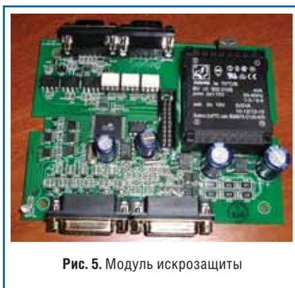
**Рис. 5.** Модуль искрозащиты
