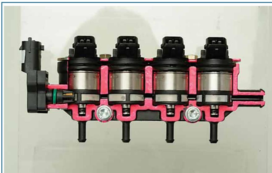
Рис. 8. Рампа с форсунками компании «MED» для системы распределенного впрыска Landi LSI E
