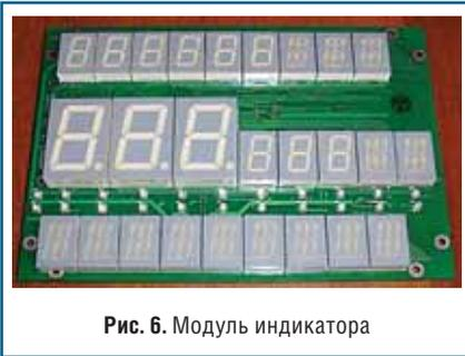
Рис. 6. Модуль индикатора
