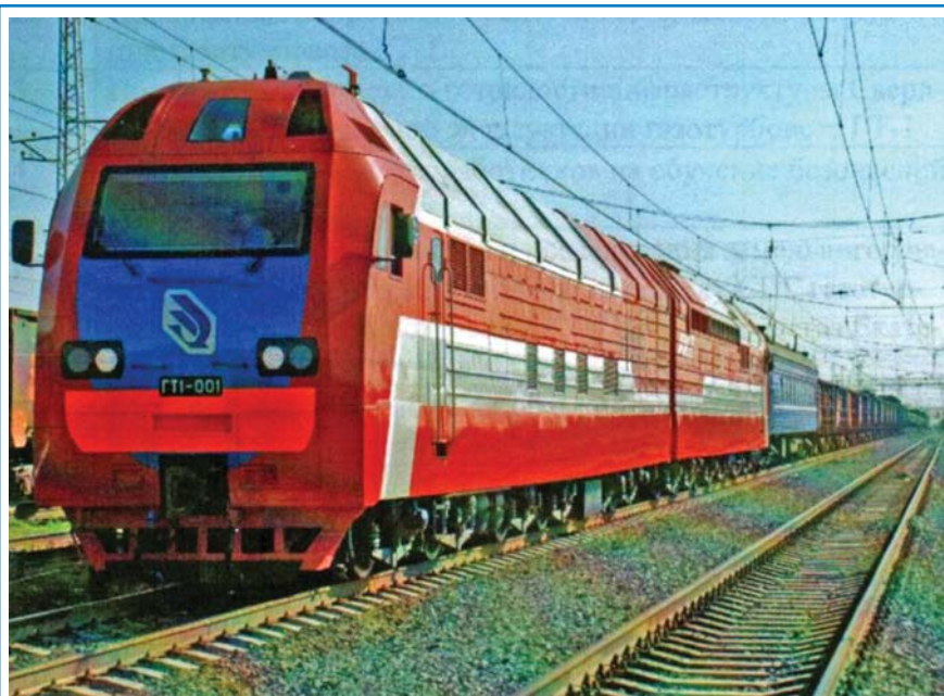
Рис. 1. Грузовой газотурбовоз ГТ-1 на СПГ разработки ОАО «Научно-исследовательский и конструкторско-технологический институт» (ОАО «ВНИИТИ», г. Коломна)
