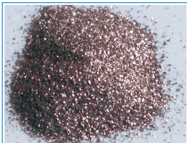
Рис. 15. Образец LaNi_5 (50-160 мкм), плакированный медью (метод ионного магнетронного распыления) [22]
