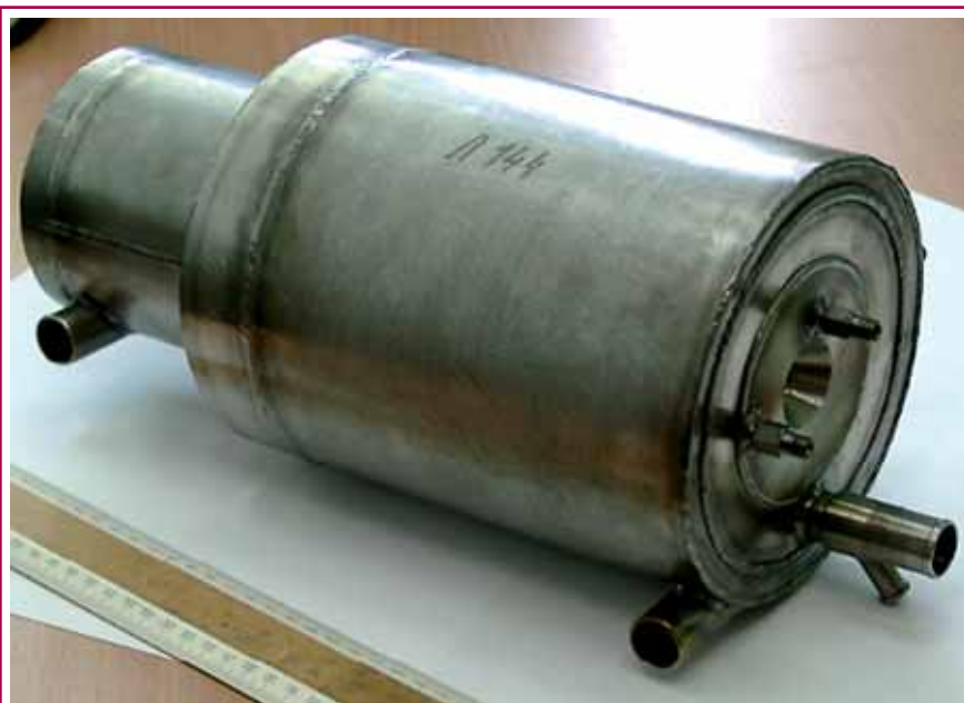
Рис. 2. Экспериментальный реактор генератора синтез-газа
