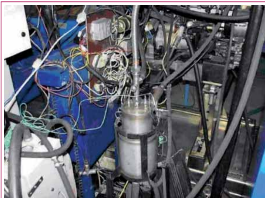
Рис. 3. Генератор синтез-газа на двигателе ЗМЗ-40522.10 на моторном стенде
