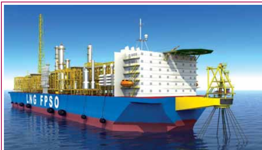
Рис. 4. ПЗ СПГ SBM Offshore – Linde на 2,5 Мт/год
