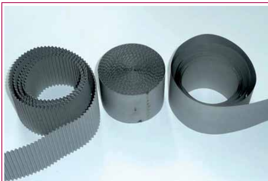
Рис. 1. Внешний вид плоских и гофрированных каталитических лент и образца монолитного катализатора
