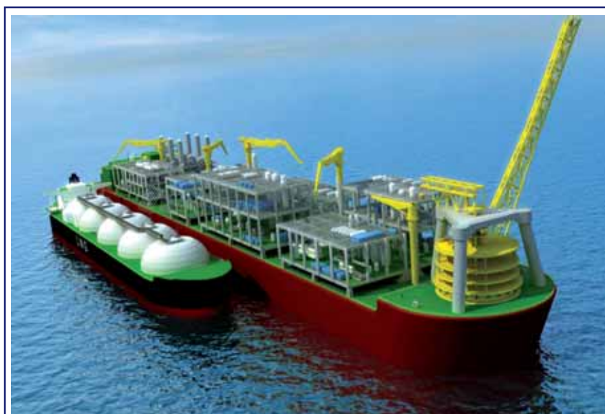
Рис. 3. ПЗ СПГ фирмы Shell на 3,5 Мт/год в виде баржи
