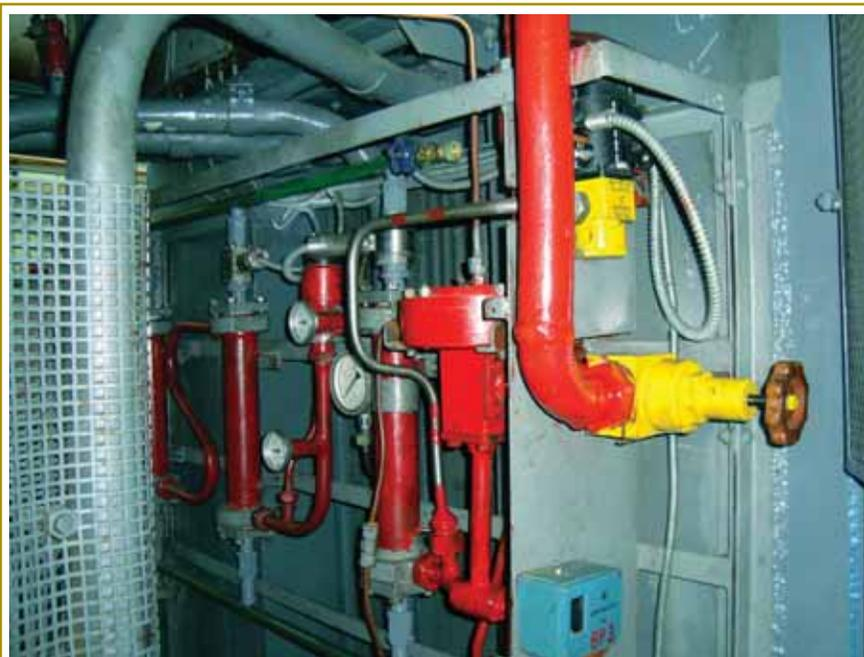
Рис. 3. Газовое оборудование газотепловоза ЧМ3ЗГ-1994
