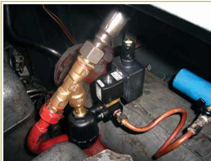
Рис. 4. Пневмоклапан и пилотный электромагнитный клапан на цилиндре дизеля газотепловоза ЧМ3ЗГ-1994
