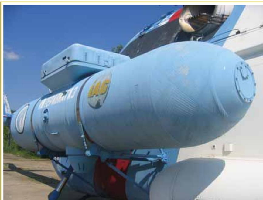
Рис. 1. Подвесной бак для газового топлива
