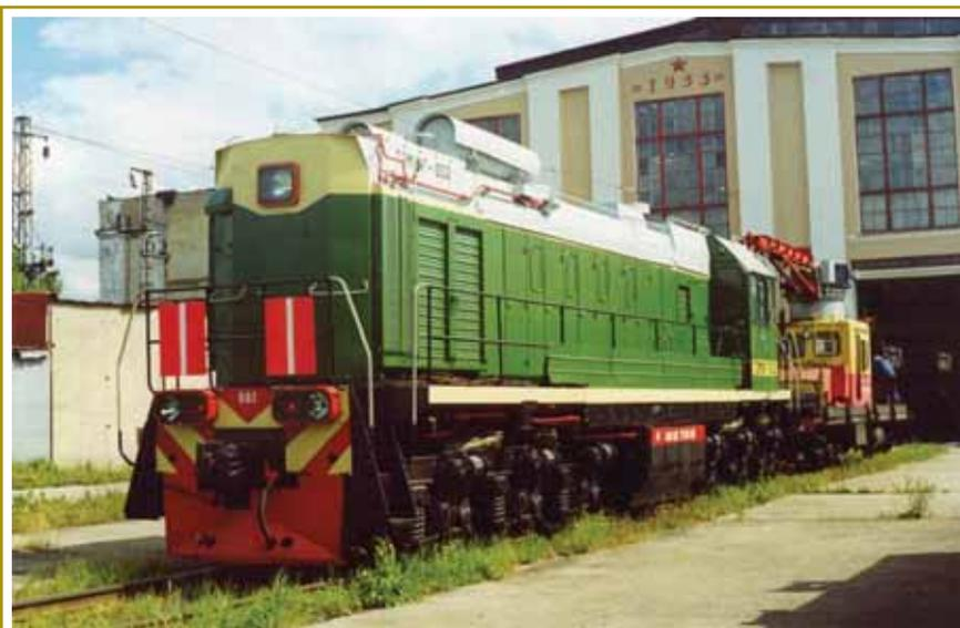
**Рис. 1.** Маневровый газотепловоз ТЭМ18Г-002 на Экспериментальном кольце ВНИИЖТ (г. Щербинка)
