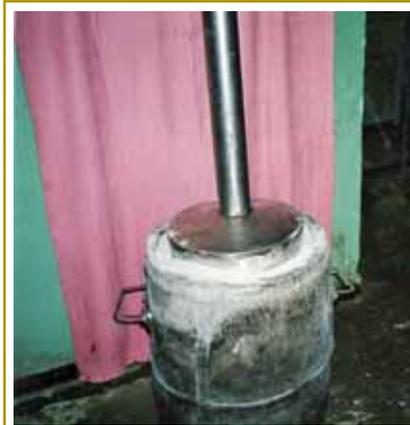
Рис. 2. Модель подземного резервуара СПГ объемом  $V = 0,03 \text{ м}^3$
