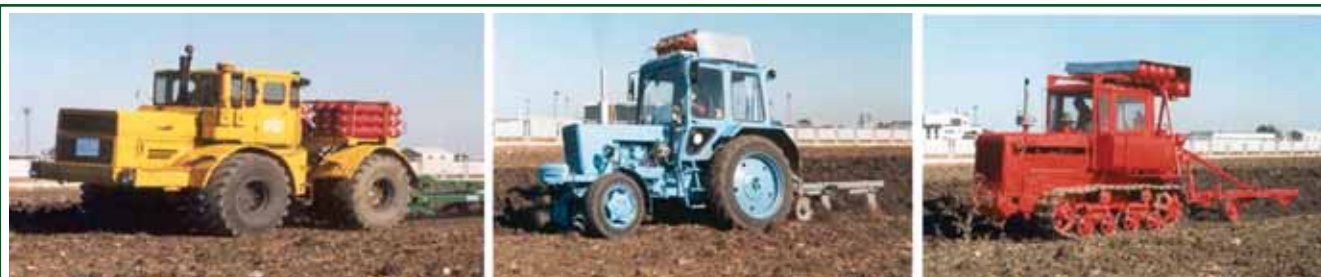
Рис. 1. Работающие на КПГ газодизельные тракторы К-701, МТЗ-82, ДТ-75 на пахоте в Ставропольском крае
