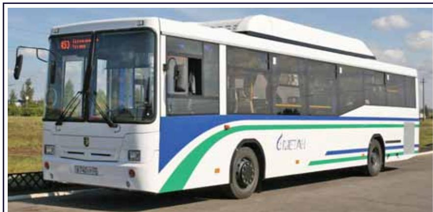
**Рис. 5.** Полунизкопольный автобус НЕФА3-5299-30-31 с газовым двигателем 820.61-260 («Евро-4»)
