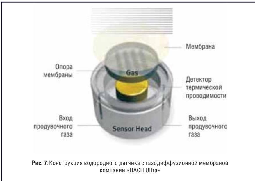
Рис. 7. Конструкция водородного датчика с газодиффузионной мембраной компании «HACH Ultra»
