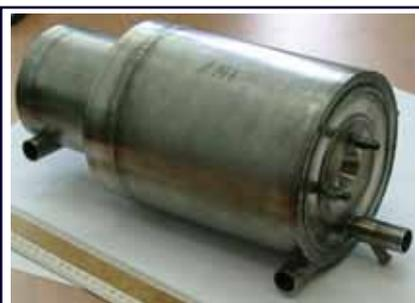
**Рис. 2.** Каталитический реактор из состава генератора синтез-газа
