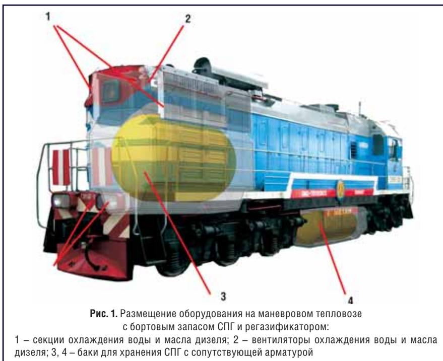
Рис. 1. Размещение оборудования на маневровом тепловозе с бортовым запасом СПГ и регазификатором:
