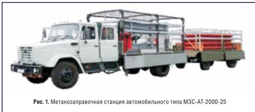
Рис. 1. Метанозаправочная станция автомобильного типа М3С-АТ-2000-25
