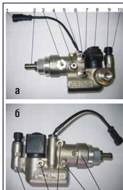
Рис. 1. Двухступенчатый редуктор давления КПГ EMER С305:
