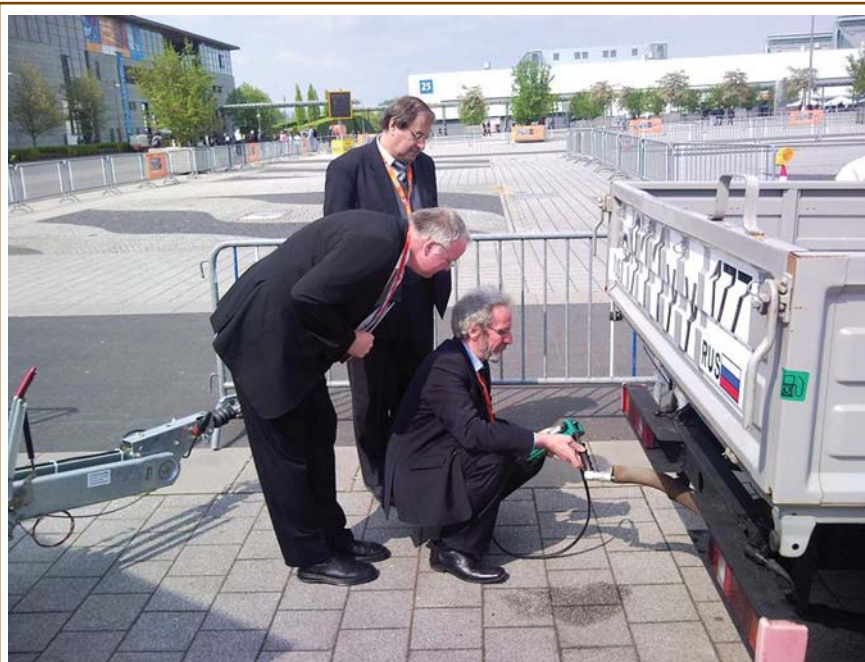
Рис. 8. Замер токсичности отработавших газов автомобиля «Соболь»
