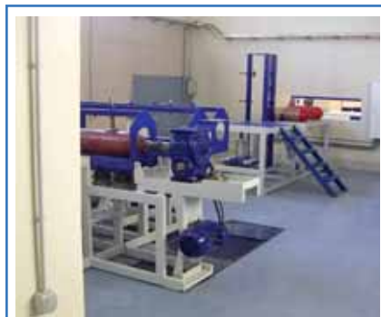
Рис. 6. Линия по освидетельствованию баллонов
