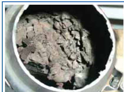
Рис. 6. Каталитический нейтрализатор, прогоревший в результате использования бензина с большим количеством металлосодержащих присадок
