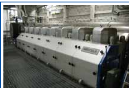
Один из четырех главных газодизельных двигателей Wartsila
