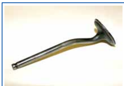
Рис. 10. Деформация стержня впускного клапана в результате удара поршня по зависшему клапану при использовании бензина с высокой концентрацией смол
