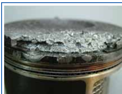
Рис. 7. Разрушенный в результате детонации поршень автомобиля (пробег автомобиля 4200 км, октановое число бензина по исследовательскому методу 75)
