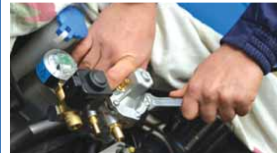
Установка редуктора для регулирования уровня давления газа
