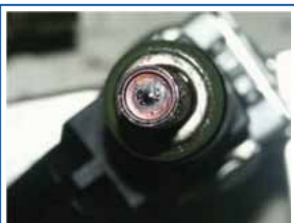
Рис. 9. Отложения углеводородов на распылителе форсунки
