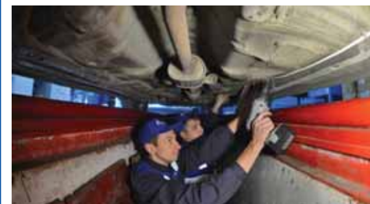
Мастера крепят газоподводящую трубку под днище автомобиля
