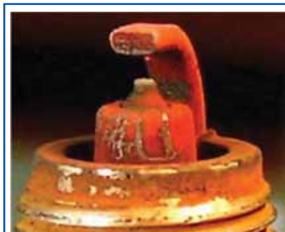
Рис. 5 Внешний вид свечи зажигания после использования бензина с присадками на основе железа
