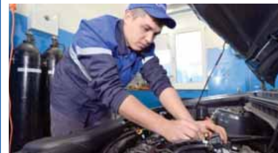
Слесарь-ремонтник IV разряда Александр Новак устанавливает рампу форсунок для подачи топлива в двигатель
