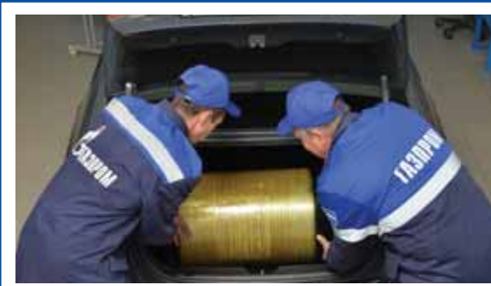
Слесари-ремонтники V разряда Александр Лисянов и Юрий Ульянов устанавливают баллон
