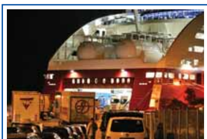
В ожидании погрузки на паром. Над аппарелью расположена система хранения СПГ
