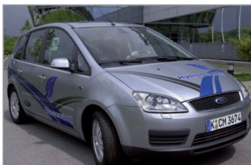
Рис. 6. Водородный автомобиль Ford Focus C-Max H 2 ICE
