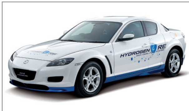
Рис. 7. Mazda RX-8 Hydrogen RE с водородным двигателем Ванкеля
