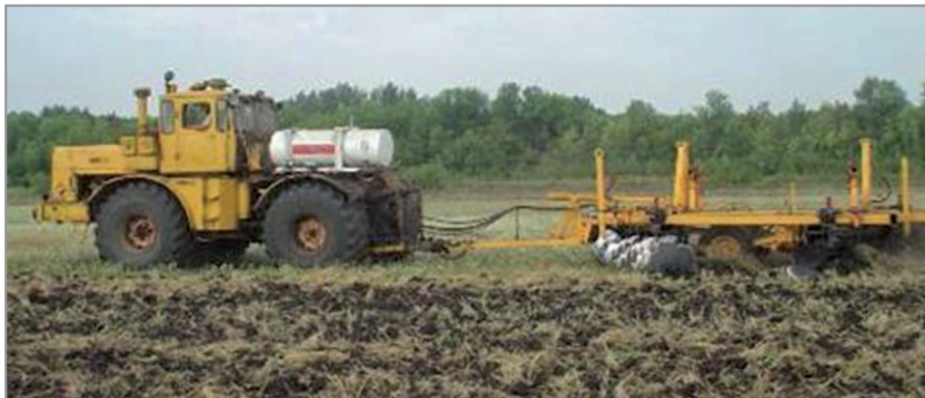
Рис. 4. Трактор К-701, работающий на СПГ, на испытаниях в Поволжской МИС
