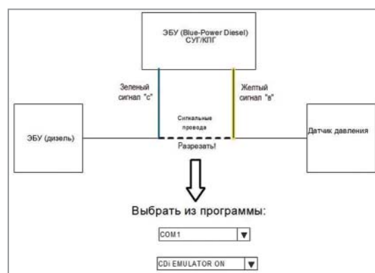
Рис. 2. Система управления современного газодизеля при работе на АВТ и ДТ
