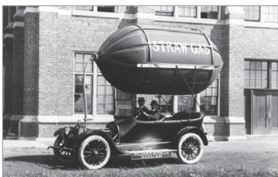
Рис. 1. Автомобиль, работающий на газе – продукте разложения соломы, хранящемся под низким давлением. Канада, 1918 г.
