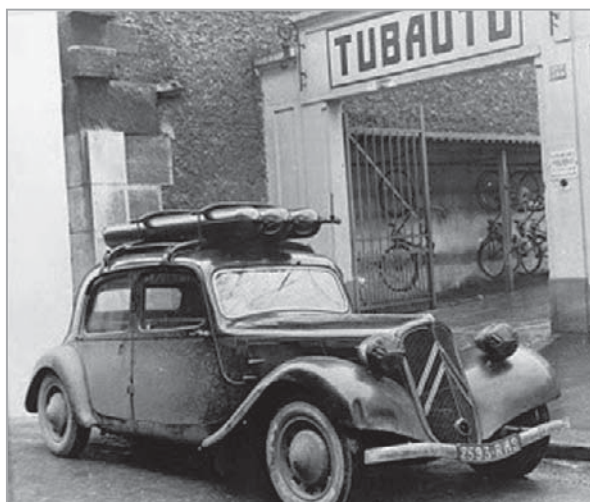
Рис. 4. Легковой Citroen с газовой аппаратурой. Снимок времен Второй мировой войны (с сайта lowtechmagazine.com )
