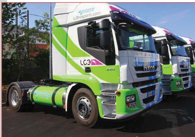
Магистральный тягач IVECO Stralis Natural Power (NP): мощность двигателя – 294 кВт, крутящий момент – 1700 Н·м; дальность пробега на одной заправке – 1500 км; 12-ступенчатая автоматическая КПП
