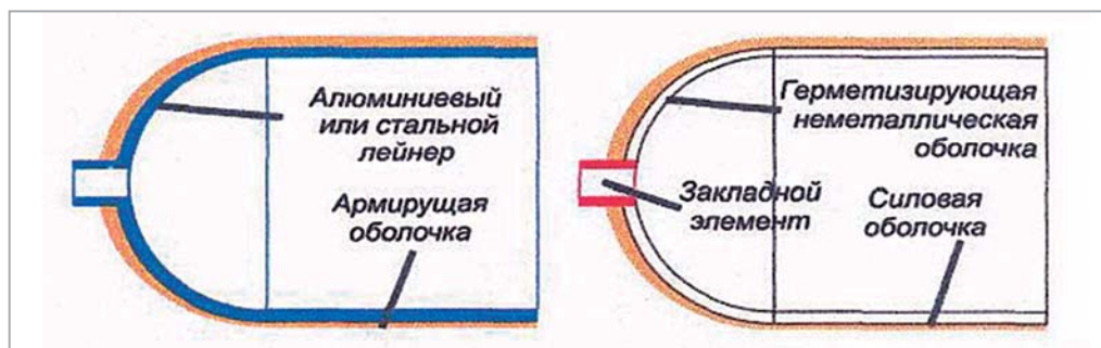
Рис. 3. Баллоны для КПП 3-го и 4-го типов
