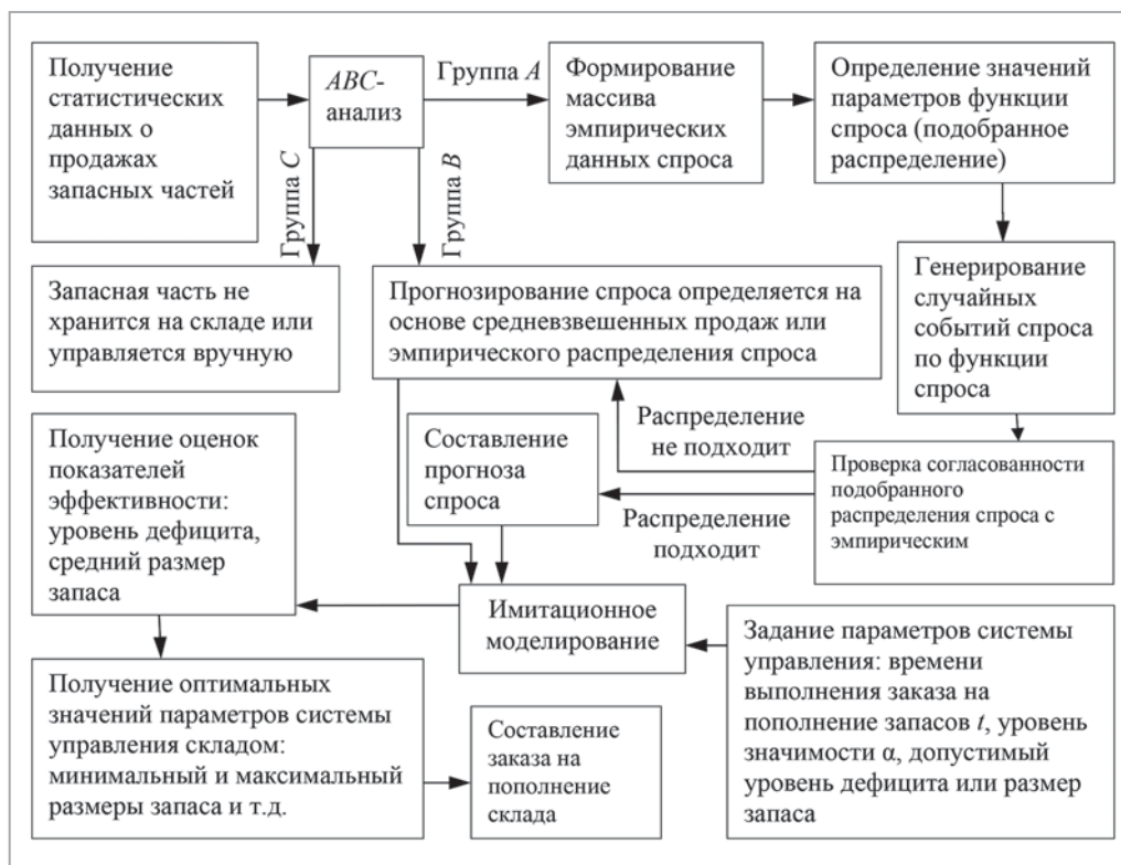
Рис. 1. Схема имитационного моделирования процесса управления складом запасных частей
