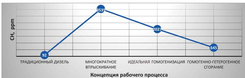
Рис. 3. Изменение концентрации CH (ppm) в зависимости от концепции рабочего процесса
