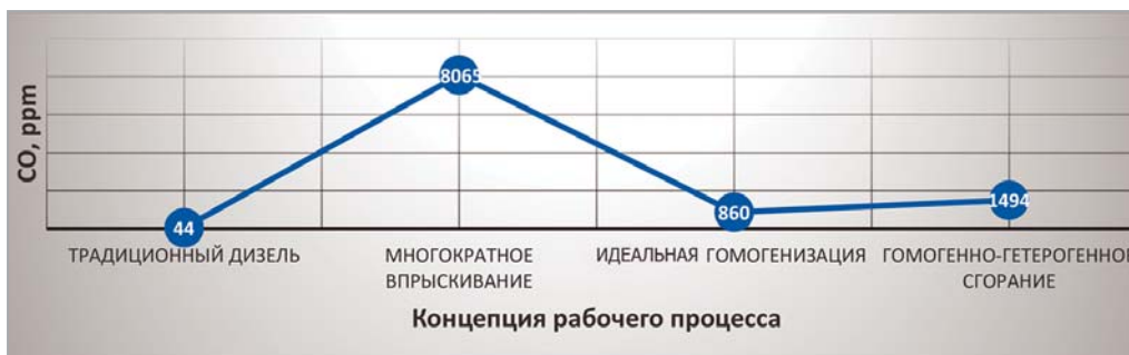
Рис. 4. Изменение концентрации CO (ppm) в зависимости от концепции рабочего процесса
