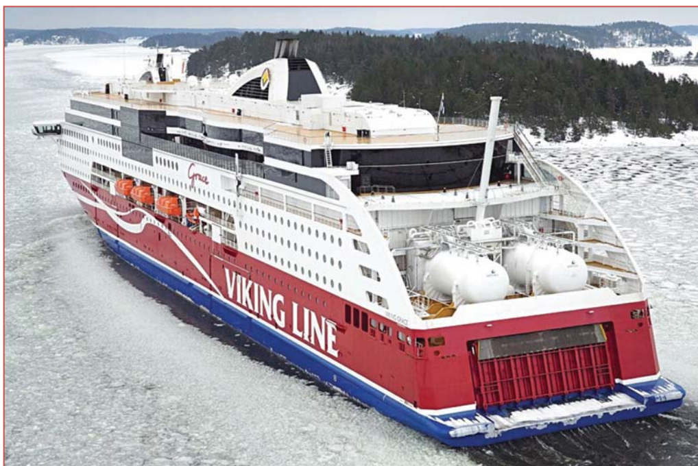
На корме парома две емкости для СПГ вместимостью по 30 т каждая
