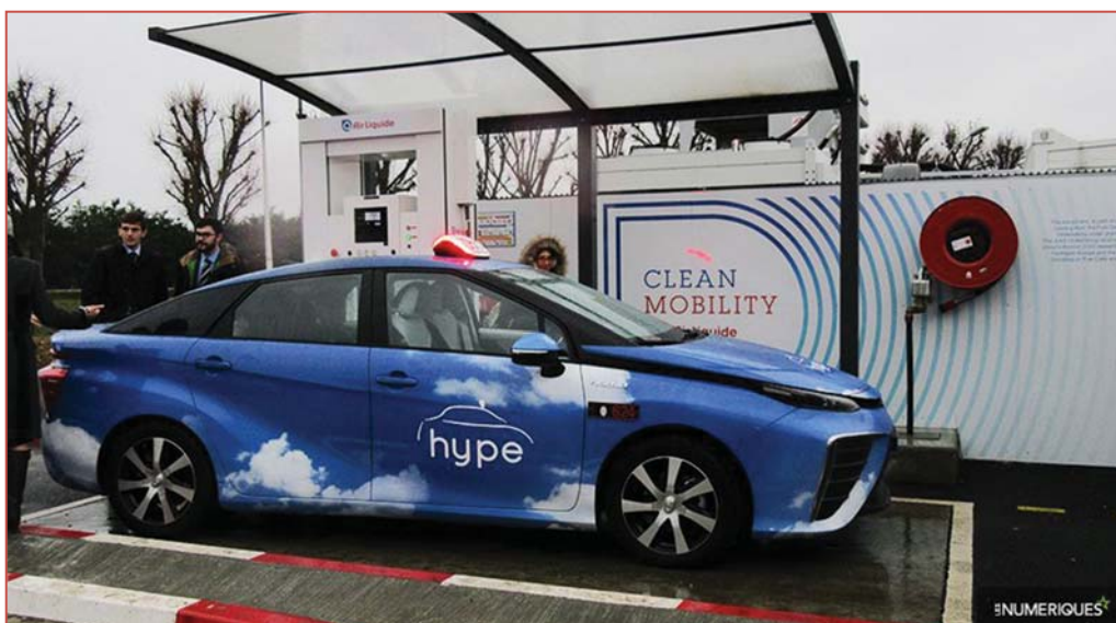
Toyota Mirai: запас водорода 5,0 кг; пробег на одной заправке 500 км; электромотор 113 кВт (152 л.с.), крутящий момент 335 нм
