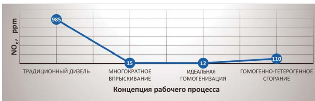
Рис. 2. Изменение концентрации оксидов азота (ppm) в зависимости от концепции рабочего процесса
