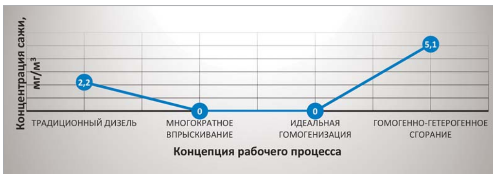
Рис. 1. Изменение концентрации сажи (мг/м³) в зависимости от концепции рабочего процесса, полученное по результатам обработки экспериментальных данных из [7, 8]
