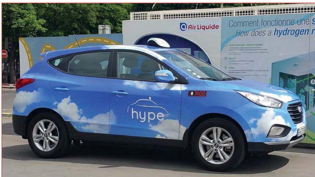
Hyundai ix35 FCEVs: запас водорода 5,6 кг; пробег на одной заправке 600 км; асинхронный электромотор 100 кВт (134 л.с.), крутящий момент 300 нм
