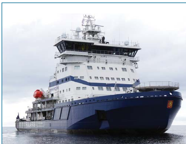
Двухтопливный ледокол на СПГ Polaris
