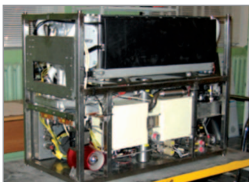
Рис. 8. Стационарная когенерационная энергоустановка «ЭЛТЭГ»
