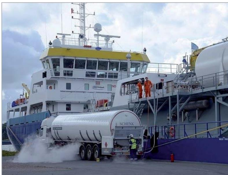
Рис. 2. Заправка судна смешанного плавания сжиженным природным газом в порту Роттердама
