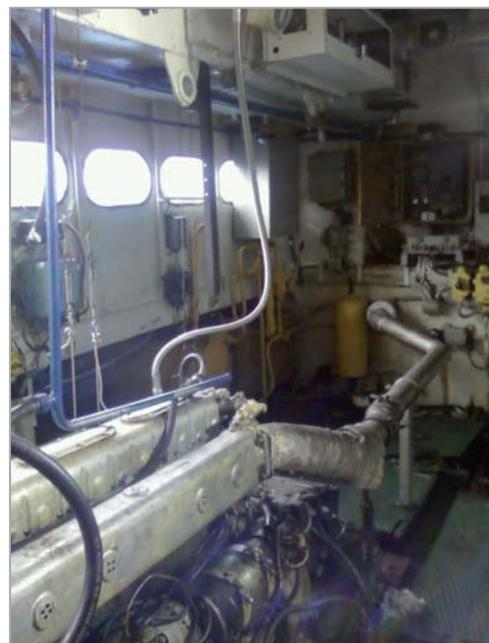
**Рис. 3.** Газодизель 3Д6 с комплектом навесного газового оборудования, размещенного на боковой стенке машинного отделения судна-газохода «Нева-6» на СПГ, для подачи природного газа
