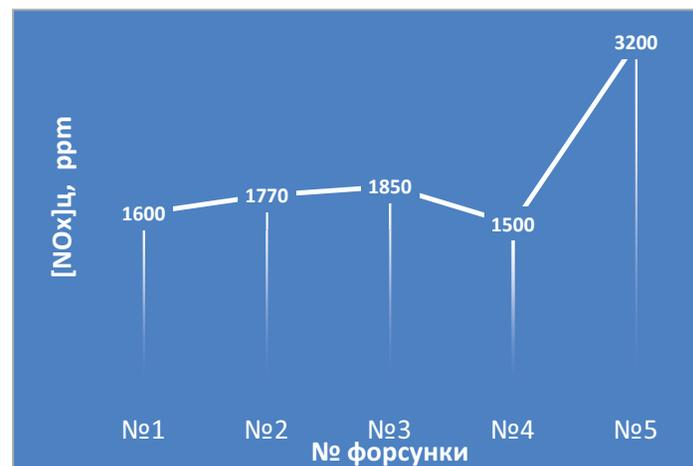
**Рис. 1.** Изменение суммарной (цикловая) концентрации оксидов азота в зависимости от конструкции форсунки (режим работы водородного дизеля):
