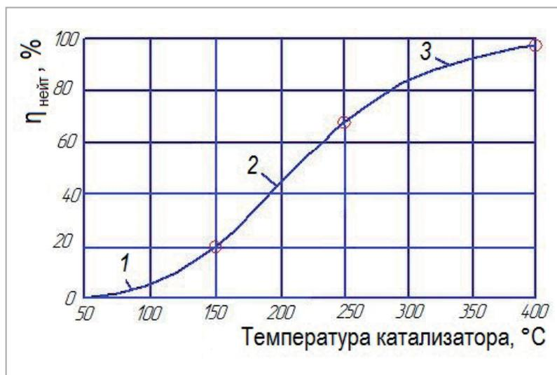
**Рис. 1.** Степень нейтрализации ОГ в зависимости от их температуры в современном катализаторе:
