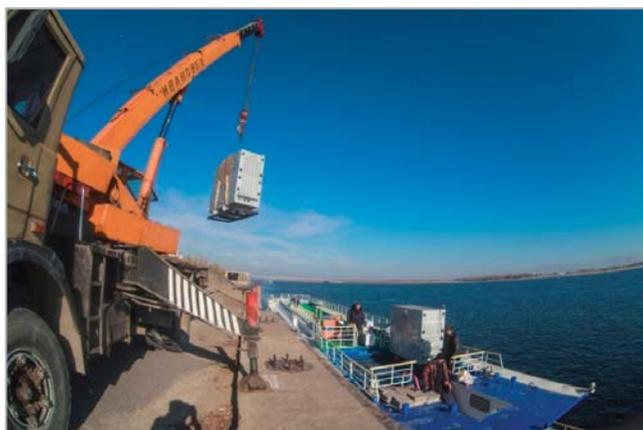
**Рис. 5.** Погрузка быстросъемных криогенных модулей с СПГ на теплоход «Нева-6»
