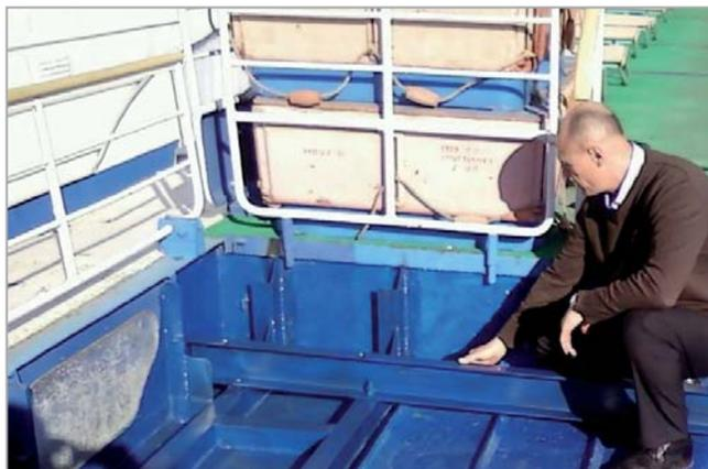
**Рис. 4.** Подготовка металлического каркаса для установки быстросъемных криогенных модулей с СПГ на верхней палубе теплохода «Нева-6»
