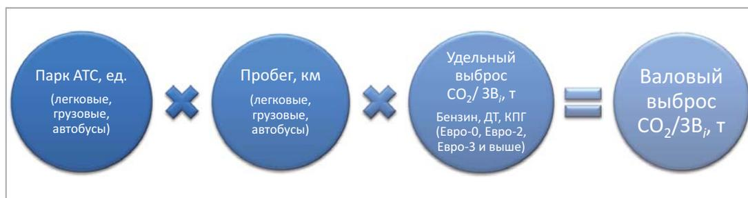
Рис. 8. Блок-схема расчета валовых выбросов CO<sub>2</sub> и ЗВ
