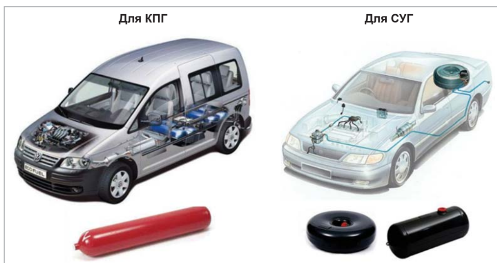
Рис. 1. Общая схема размещения газобаллонного оборудования на легковых автомобилях
