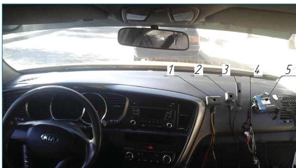
Рис. 5. Внешний вид измерительного приборного комплекса SIGMA и телеметрического электронного блока GALILEO SKY, установленного на автомобиле KIA Optima: 1 – цифровой индикатор; 2 – GPS-антенна; 3 – GSM-антенна; 4 – электропроводка измерительного комплекта; 5 – блок навигатора GALILEO SKY (GPS/ГЛОНАСС)
