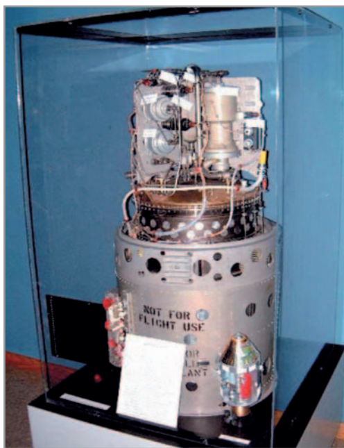
Рис. 21. ЭУ на РКТЭ космического корабля Apollo (экспонат Музея космической истории, Нью-Мексико, США)
