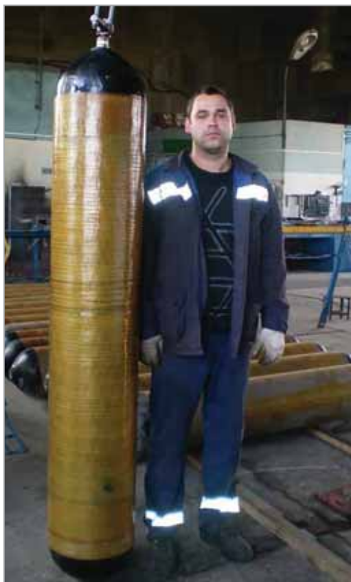
Рис. 3. На переосвидетельствовании длинномерного газового баллона
