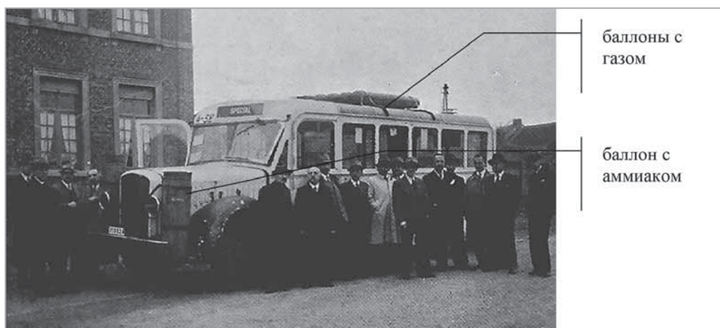
Рис. 3. Фотография бельгийского автобуса на аммиаке во время Второй мировой войны, оснащенного оборудованием для использования аммиака, емкость для хранения аммиака размещена на передней части автомобиля, а цилиндры с газом на крыше автобуса [1]
