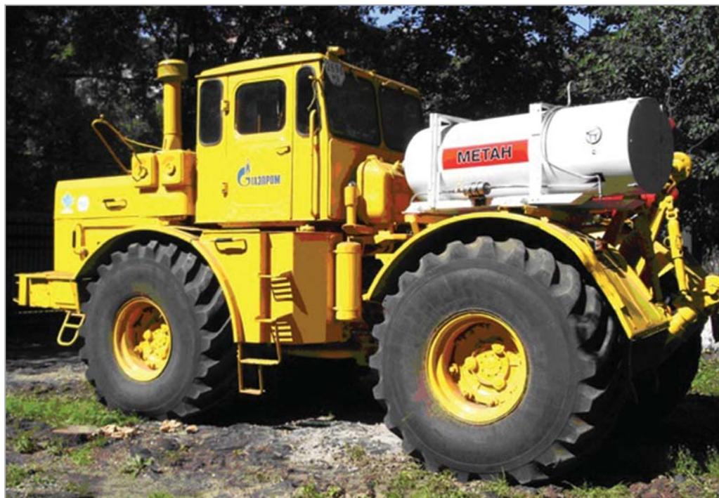
Опытный образец трактора К-700 на СПГ
