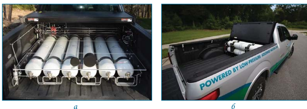
Рис. 11. Бортовая система аккумуляции природного газа, выполненная в виде батареи цилиндрических сосудов, установленной в кузове автомобиля Ford 150 (а и б), а также блоки адсорбционного материала (в) компании ANGP (США) [10]
