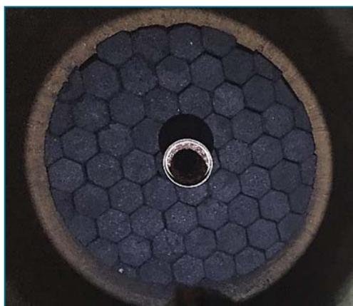
Рис. 12. Сотовая структура укладки формованных шестигранных блоков адсорбента в системе хранения цилиндрического сечения на базе стандартного баллона БП-100-14.7-317/1525 (ОМЗ), разработка ИФХЭ РАН [4]
