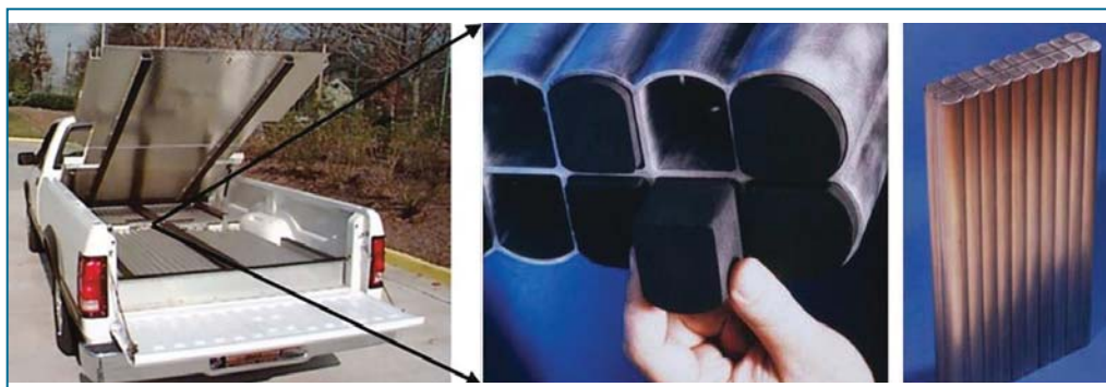
Рис. 5. Прототип бортовой системы хранения природного газа метана на основе углеродного адсорбента (1997 год). Корпус выполнен из алюминия путём экструзии [6]
