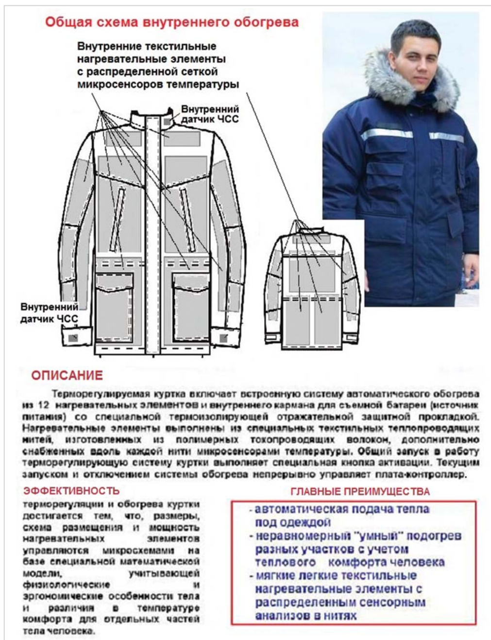
Рис. 3. Костюм с автоматической терморегуляцией. Области применения: на всех промышленных объектах, в суровом климате, в горах, экспедициях, геологоразведке
