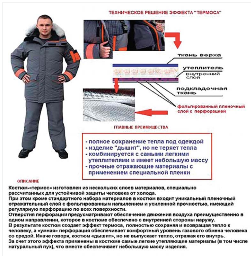
Рис. 1. Костюм-термос для работы в арктическом шельфе. Области применения: на всех промышленных объектах, в суровом климате, в горах, экспедициях, геологоразведке
