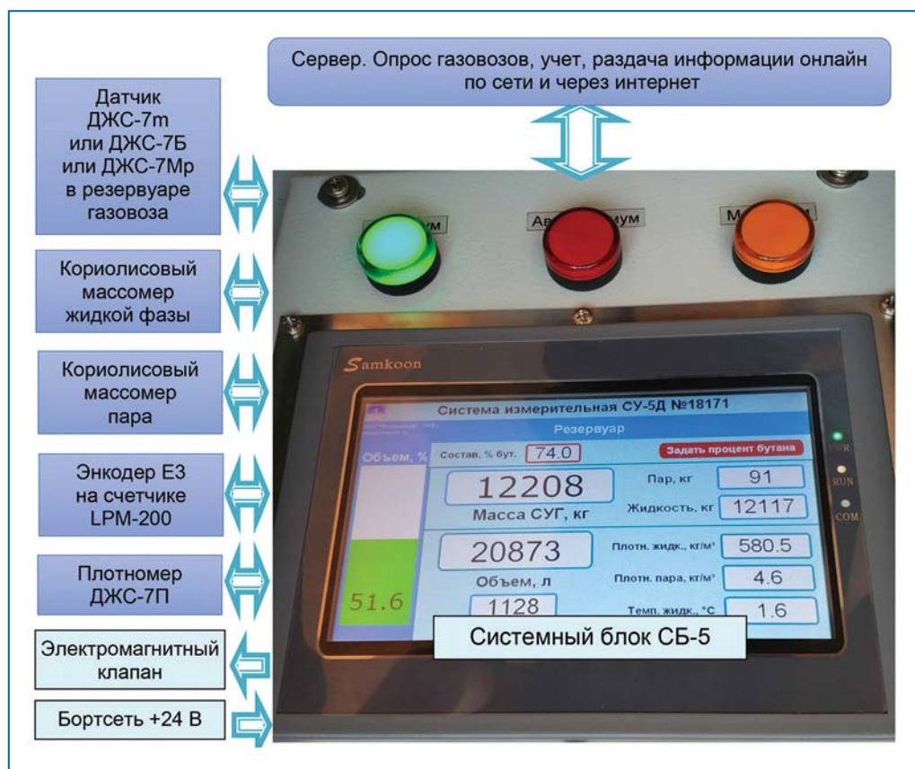
Рис. 1. Система измерительная СУ-5Д-М для газозовозов
