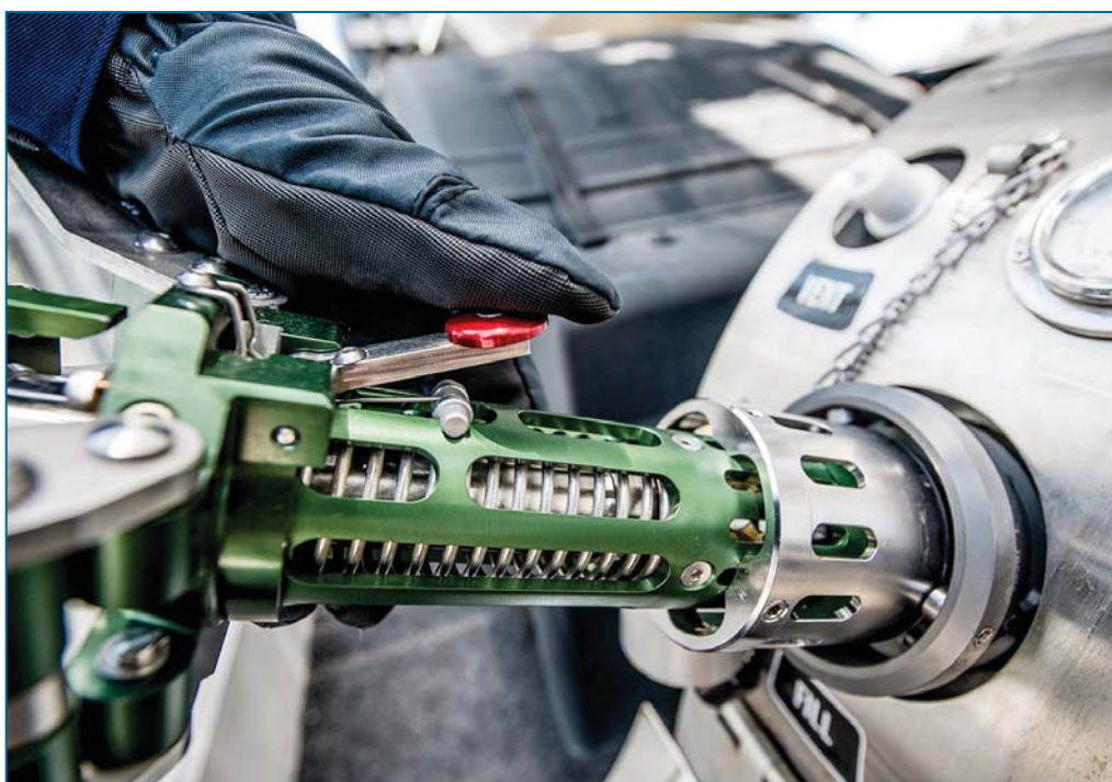
Рис. 1. Заправочное устройство RegO Macro CryoMac3 обеспечивает комплексное решение для заправки транспортных средств СПГ
