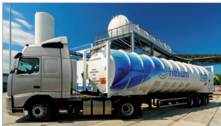
Автомобильная цистерна-контейнер для транспортировки жидкого гелия
